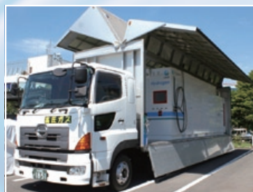
「今回開発した移動式水素ステーション」 (ハイドロ シャトル搭載)
