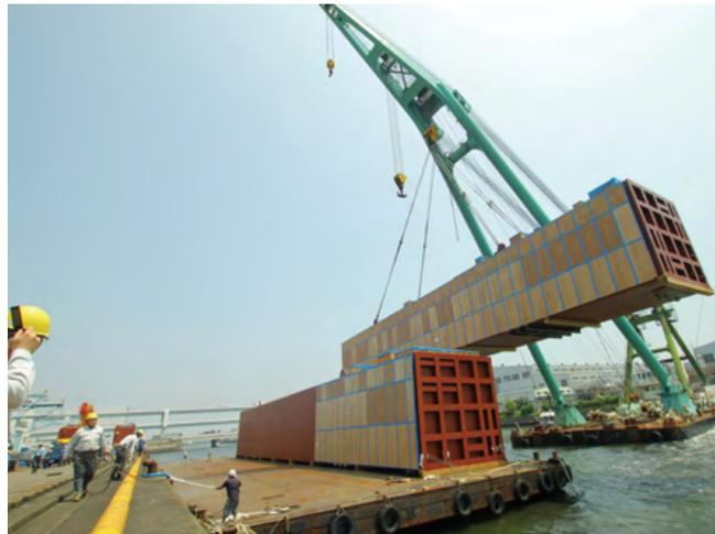
サソール社向けに輸送中の大型空気分離装置
