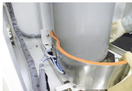
NACS HEATR を 47L 容器へ装着する様子
