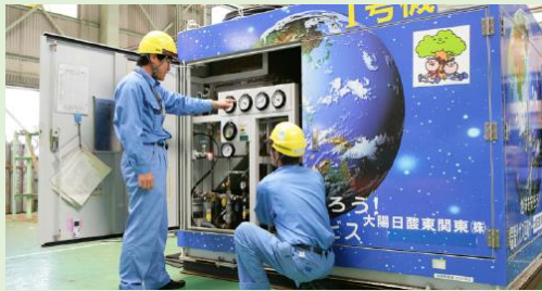
SF6 回収装置
