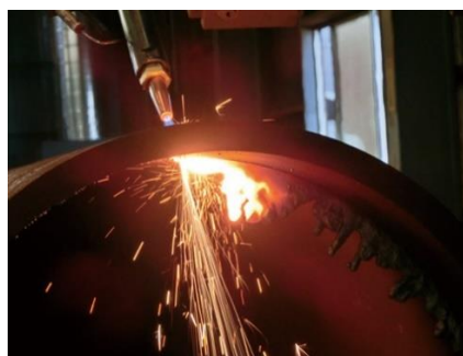
サンカッター-RHL-1 切断の様子
