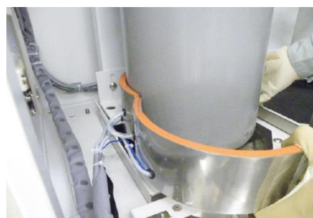
NACS HEAT®を 47L 容器へ装着する様子
