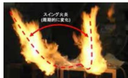
自励振動現象により広範囲を効率よく均一に加熱する Innova-Jet® Swing の火炎
