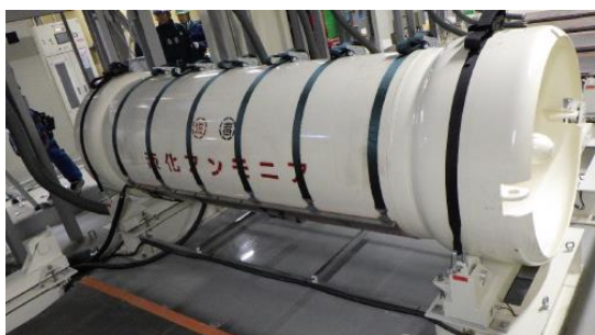
NACS HEAT®が装着された 1860L 容器
