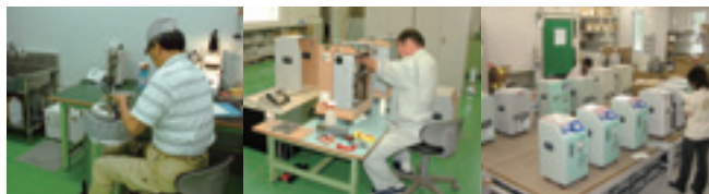
大陽日酸メディカル・テクニカル・サービスセンターでは、レンタル品・修理品の定期保守点検、修理、オーバーホールを実施し、いつでも貸し出せるように倉庫に保管している。作業は熟練した専属の作業員が行う。出荷時にも患者さん宅にお届けすることを念頭に再度チェック。
