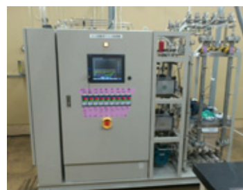
大陽日酸が開発した窒素等の不純物を除去する水素精製装置
