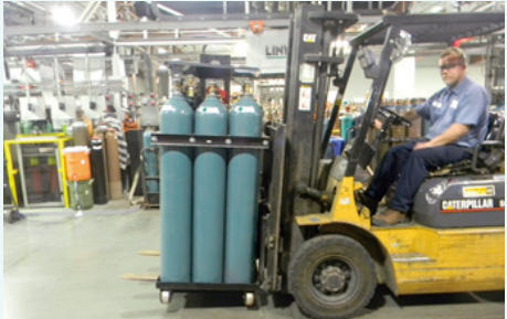
シリンダー移動を手動で行うことによる怪我を防ぐために、ハンドリング装置を導入
