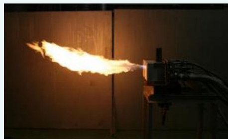
自動振動現象により広範囲を効率よく均一に加熱する「Innova-Jet® Swing」の火炎
