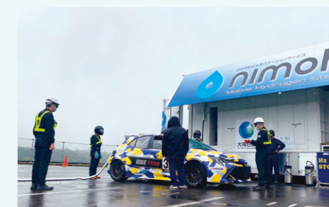
水素エンジン車への水素ガス充填風景
