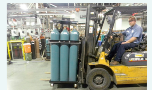
シリンダー移動を手動で行うことによる怪我を防ぐために、ハンドリング装置を導入
