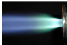
製鋼用酸素バーナ・ランス [SCOPE-JET®]
